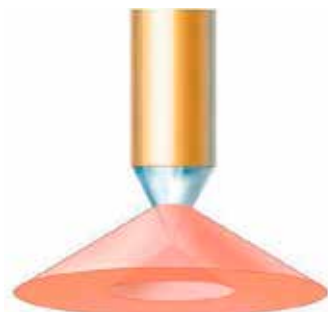
Obr. 3.4.2.2.3 Geometrie vyzařování paprsku výstupu laserové energie z kónického hrotu
